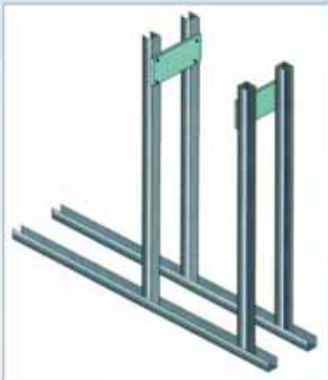
Ständerwand aus UW- und CW-Profilen.
